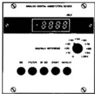
Dient zur Umwandlung der Ausgangsgleichspannungen analoger Meßgeräte in der Akustik und Schwingungsmeßtechnik (vorzugsweise der Anzeigeteile 02022 und 02036) in digitale Meßwerte. Anzeige der Meßwerte in mV oder in dB 4stellig mit Vorzeichen. Ausgabe der Meßwerte in BCD-Code.
