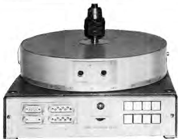
laufenden Pegelschreiber 02 013 direkt auf Polarkoordinatenpapier aufgezeichnet werden kann. Darüber hinaus ist die Möglichkeit des automatischen Stops in vorprogrammierten Winkelstellungen gegeben, um diskrete Meßwerte zu ermitteln und in digitaler Form weiterzuverarbeiten.
