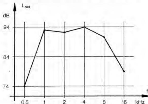
Die bereits unter normalen Bedingungen recht große Meßunsicherheit von etwa  $\pm 2$  dB erhöht sich nochmals, wenn das zu prüfende Gerät im Hauptfrequenzbereich der Kugelfallschallquelle einen unebenen Frequenzgang aufweist. Dieser Zusatzfehler läßt sich durch Berücksichtigung eines Korrekturwertes wieder ausgleichen, wie er zu jedem Schallpegelmesser SPM 101 individuell mitgeliefert wurde.
