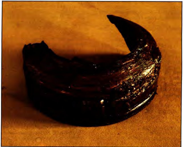
Schadenfolge durch nicht erkannte Schädigung eines Lagers
