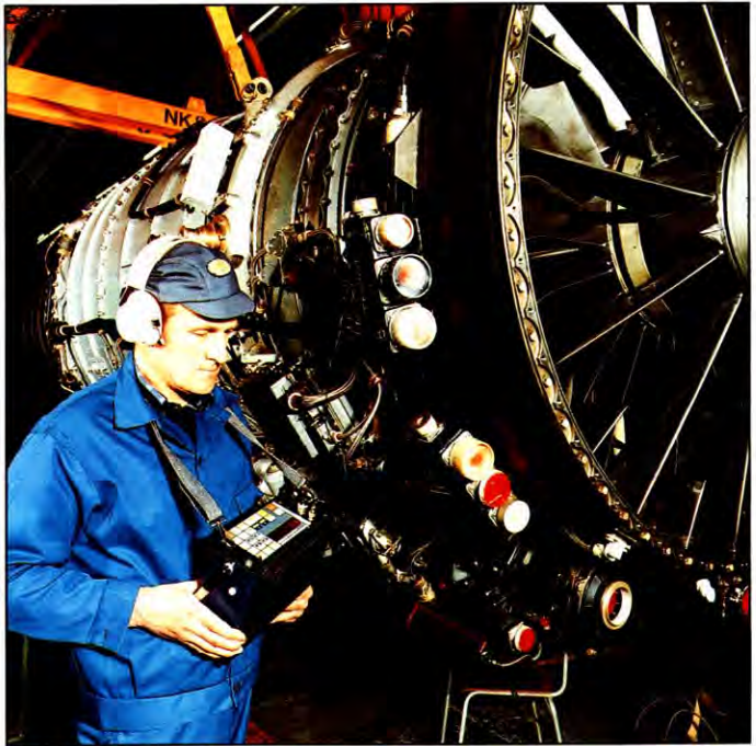
Schwingungsmessungen an einem Strahltriebwerk des Typs D-30 KU
